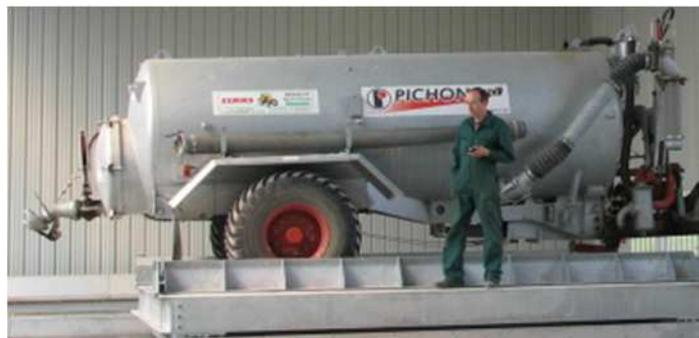
**Photo 5 : Tonne à lisier avec une buse unique, [M. Rousselet, Cemagref]**
