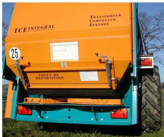
Photo 2 : Vue arrière d'un épandeur à table d'épandage [J. Mazoyer, Irstea]
